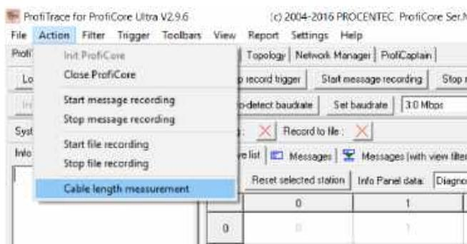
Mit der Leitungslängenmessung können Sie die Länge einer PROFIBUS-DP-Segmentleitung von einem Ende zum anderen berechnen. Dies kann nur ohne aktive Master auf dem Bus erfolgen, Sie müssen also alle SPS, PLS, HMI, Programmierwerkzeug oder ein anderes Mastergerät abklemmen oder sperren. Die Leitung muss passiv sein. Die Messung funktioniert NICHT über einen Repeater!
