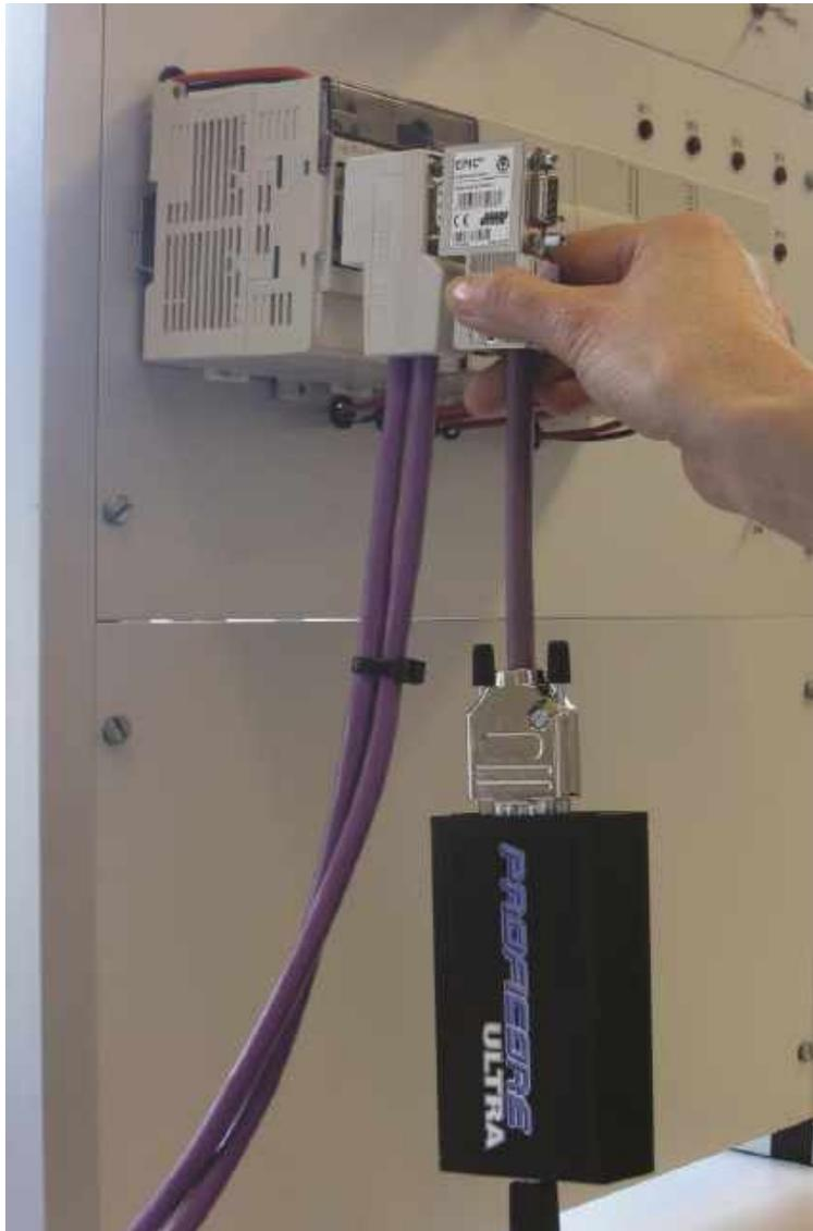
Abb. 9 - ProfiCore an ein DP-Installation anschließen
